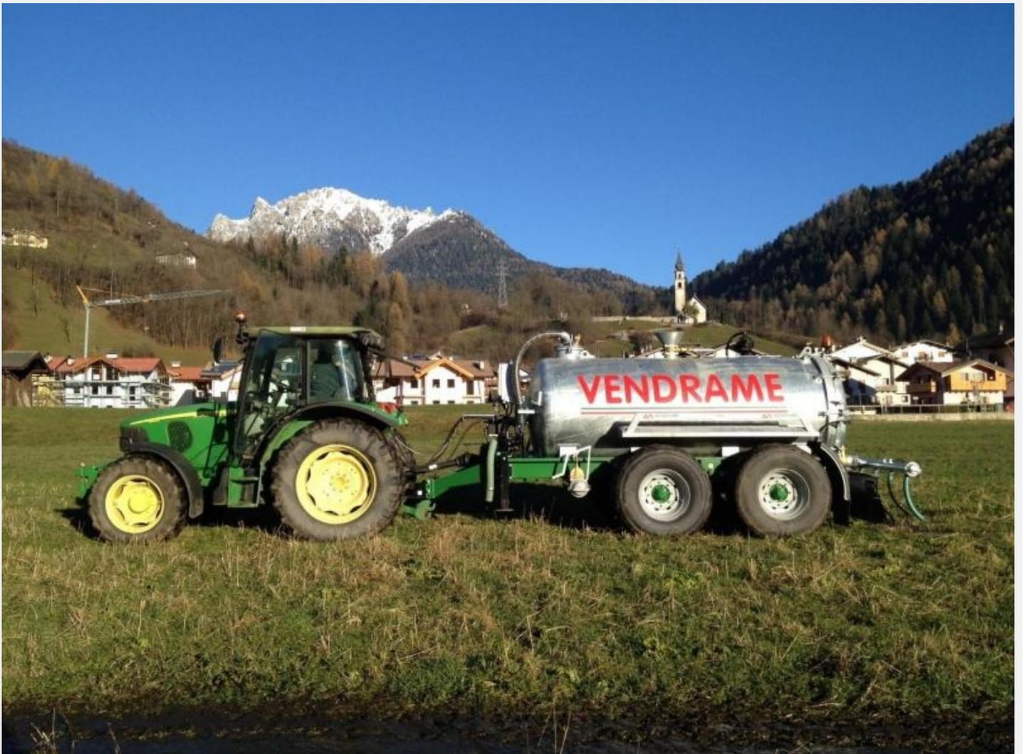
Carrobotte spandilquame VENDRAME con serbatoio da 5.840 litri. Telaio con 2 assi (fisso + sterzante). Gruppo Garda 6500 con decompressore 9.000 litri. Gettone fertirrigatore. Barra posteriore spandimento liquame. Pulsantiera con quadro elettrovalvole.
